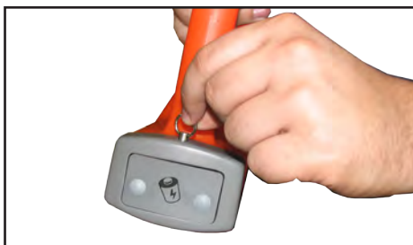
а) Выдвинуть фиксатор и освободить батарейный отсек
