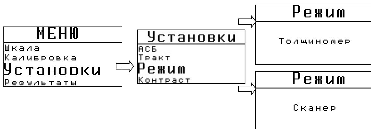
Рис.2-9 Выбор режима измерения толщины
