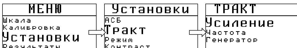
рис.5-5 Регулирование параметров тракта
