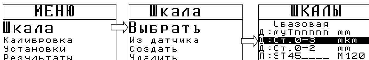
Рис.2-4 Виды экрана при загрузке шкалы из памяти прибора
