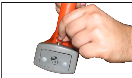
а) Выдвинуть фиксатор освободить батарейный отсек
